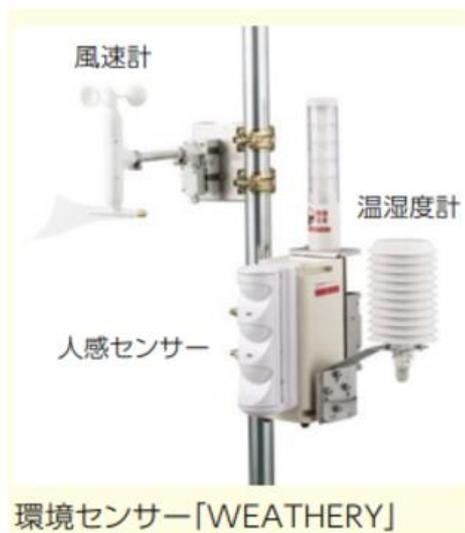
これは、温湿度、風速、人感の3つのセンサーが内蔵されており、基準を超える温湿度や風速を検知すると、表示灯と音声で作業員に警告をすると同時に、管理者へメールで通知する仕組みとなっている。
