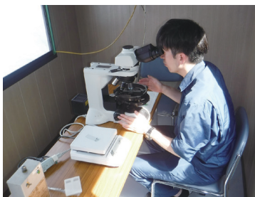
▲石綿の測定立入検査の様子
