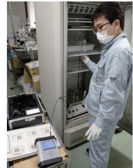
海水の生分解試験での水質測定
