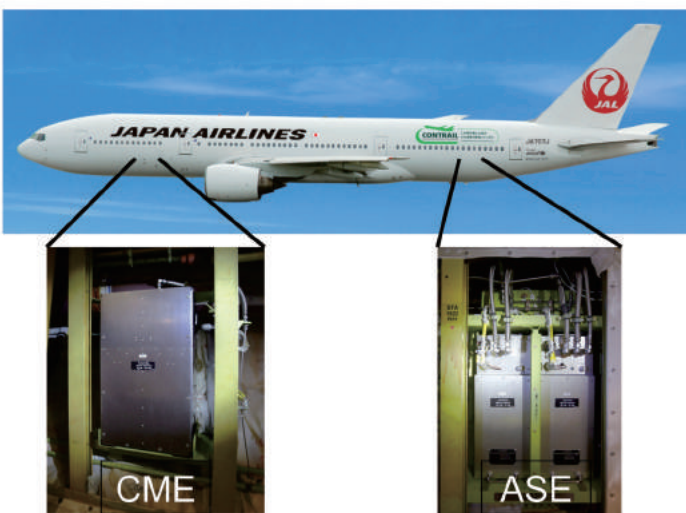
▲図1. ボーイング777-200E型機とその前方貨物室に搭載されたCMEおよび後方貨物室に搭載されたASE
